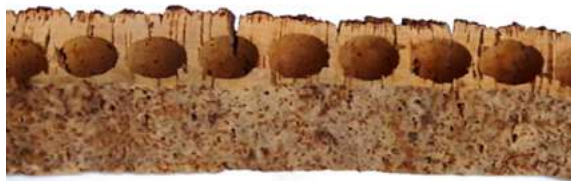
Figura 26 – Fetta di Standard dove è possibile carotare tappi naturali di qualità nonostante la pancia irregolare e chiodata
